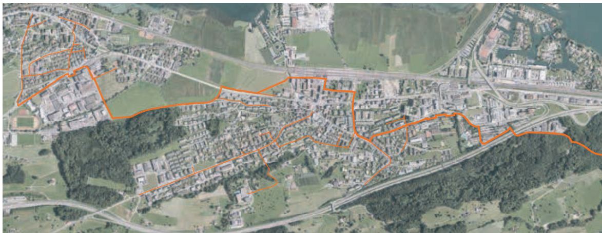
Die roten Linien auf dem Plan zeichnen nach, wo die Leitungen für das Fernwärmenetz durch Pfäffikon und Freienbach gezogen werden sollen.
